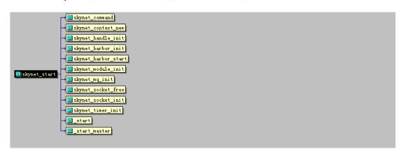
启动初期,会初始化一系列全局结构包括: E(全局 luastate), HARBOR (当前 skynet 的 harbor 号), H (全局 handle storage 结构,管理所有 context),Q (全局(两级)消息队列), M (全局 modules,存储所有 module 信息), TI(全局定时器), SOCKET\_SERVER (TCP SOCKET Server), REMOTE (harbor 服务).
